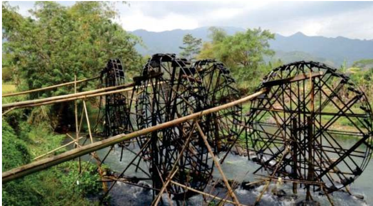
Gambar 6.1. Kincir air untuk mengairi sawah.
